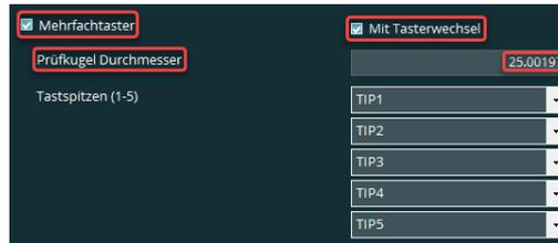
Abhängig von dem unter „Taster“ (siehe Kapitel: [Benutzeroberfläche](#), Abschnitt: [Auswahl des Tasters und Tastsystems](#), Punkt: [Taster](#)) gewählten Taster können die Tastspitzen definiert werden.
