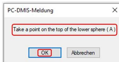
wird mit „OK“ bestätigt und am Nordpol der Kugel „A“ ein Messpunkt aufgenommen. Anschließend wird die Kugel mit 5 Punkten im CNC-Modus gemessen.
