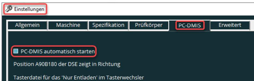
Ist die Checkbox (siehe oben) aktiviert und PC-DMIS nicht gestartet, wird die zuletzt verwendete PC-DMIS Version gestartet. Ist PC-DMIS bereits gestartet und die Checkbox aktiv, wird diese ignoriert.
