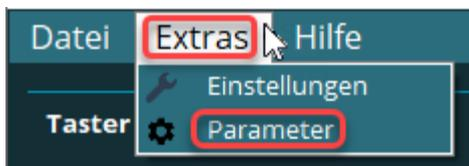
Wird diese Option gewählt, wird das Dialogfenster „Messparameter“ geöffnet, in welchem globale Einstellungen für die Messungen (siehe Kapitel: [Benutzeroberfläche](#); Abschnitt: [Auswahl und Ablauf der Tests](#)) vorgenommen werden können.
