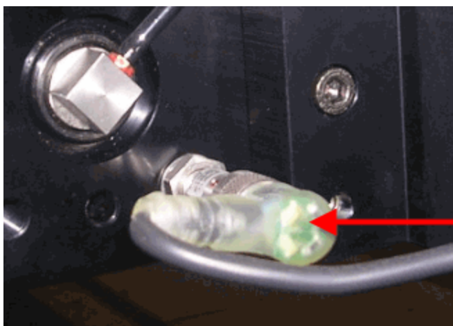
緑色と濃黄色のLED照明とのソレノイド接続
