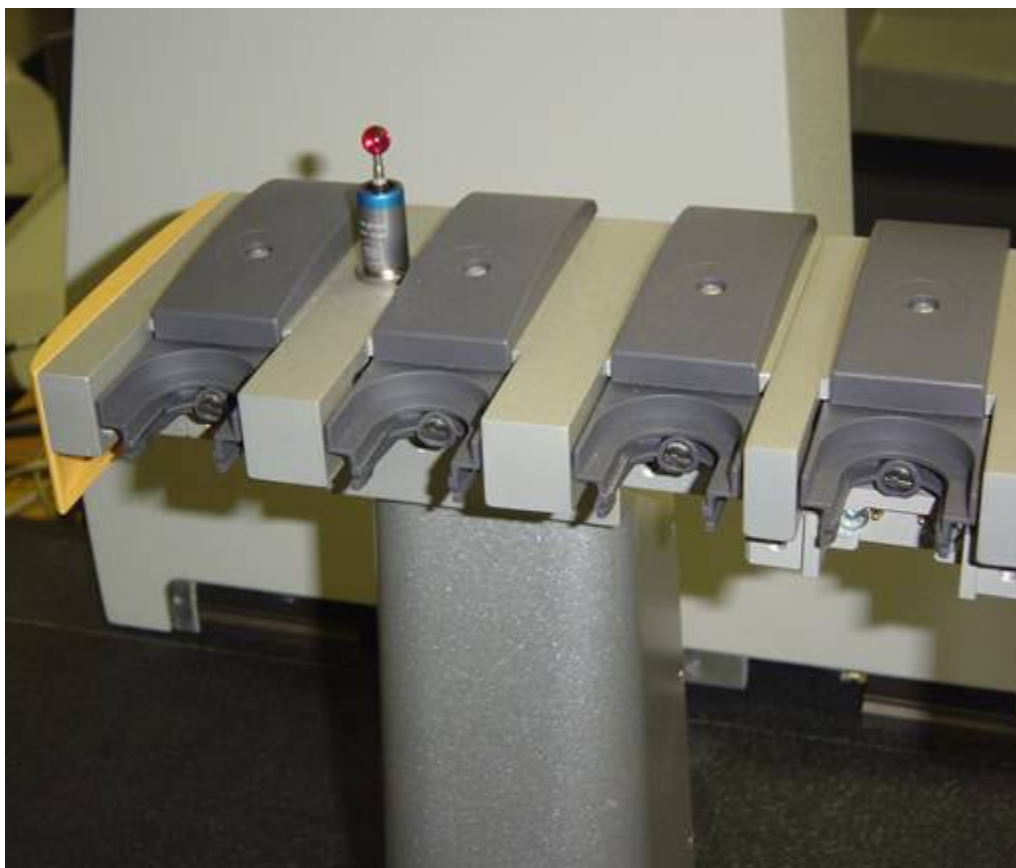
校正前の開いたポートの蓋を示す例。
