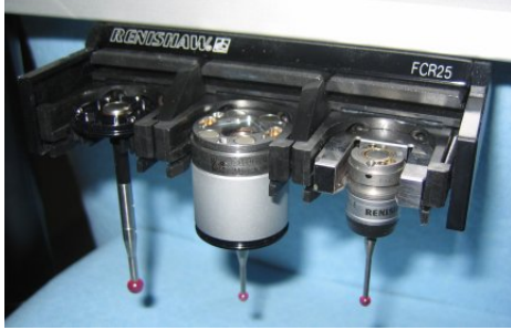
FCR25プローブチェンジャーのインサート及びプローブタイプ
