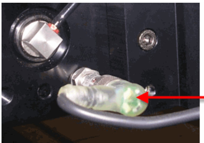
螺线管连接了绿色和黄色LED灯
