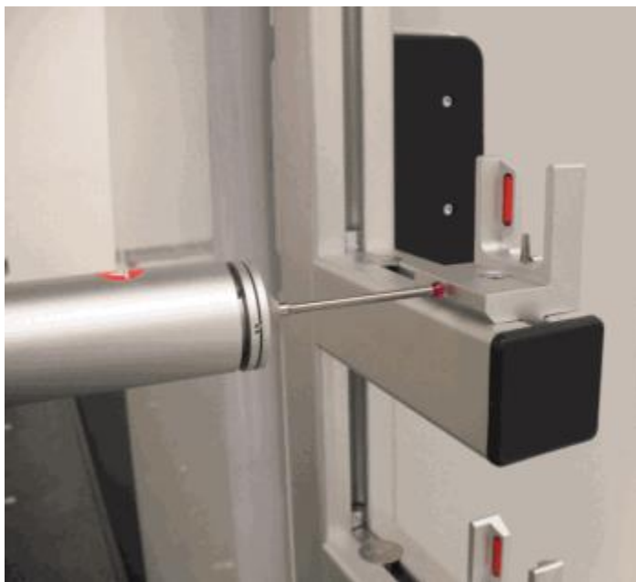
顶部端口平面和垂直正面上的水平测点
