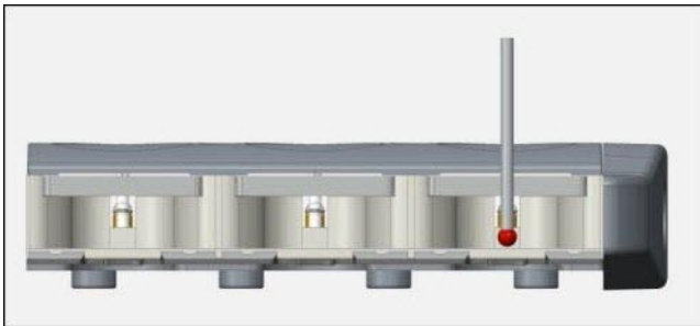
端口 3 的后表面上第一次触测的视图
