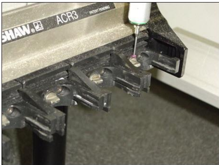
显示端口 4 背面内部第二次手动测头采点的示例。
