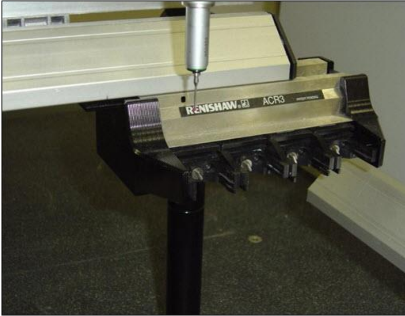
ACR3 测头更换架位于其行程范围右侧的示例。
