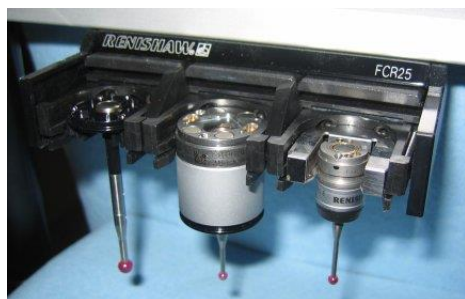
FCR25 测头更换架插入件和测头类型
