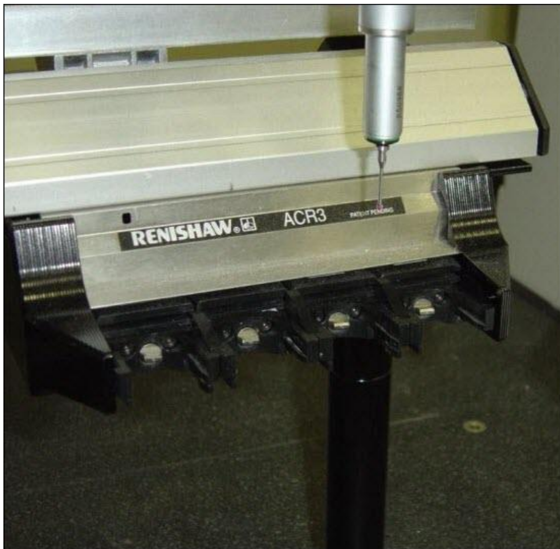
使用垫片保持空端口张开的 ACR3 测头更换架示例。
