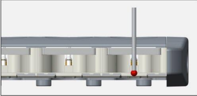
在测头支撑件的顶部表面上进行第四次触测的视图
