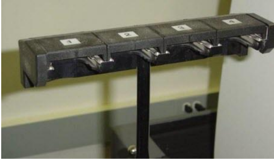
Renishaw SP 600 Stylus更换架 (SCR600)
