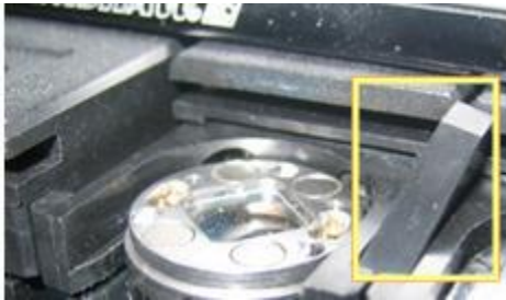
确保两个端口的盖子为打开状态的垫片
