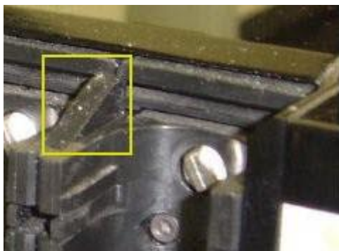
多个相邻端口之间垫片的示例。
